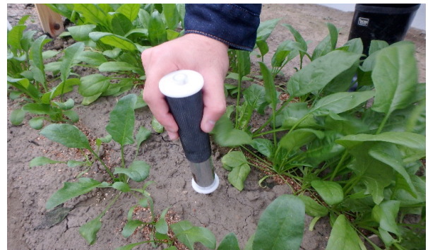
写真2 土壌硬度調査（11/14）
